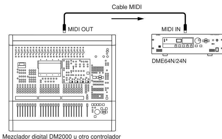
Si el conector [MIDI OUT] del DME64N/24N está conectado al conector [MIDI IN] de un SPX2000 o de una unidad de efectos digitales similar, y el DME64N/24N y el SPX2000 están configurados adecuadamente, las operaciones de cambio de programa del DME64N/24N provocarán la activación del efecto correspondiente en la unidad de efectos.
