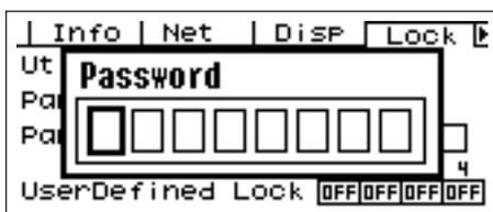
Utilice las teclas [◀] y [▶] para situar el cursor y el disco para introducir el carácter deseado en la posición del cursor. Cuando haya introducido todos los caracteres de la contraseña, pulse la tecla [ENTER].
