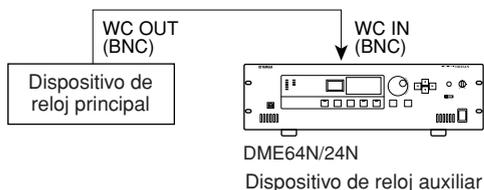
Para distribuir la señal de reloj de un dispositivo a varios dispositivos auxiliares, se puede utilizar una caja de distribución de señales de reloj o una conexión de tipo margarita.
