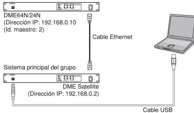
Puede conectar los dispositivos del mismo grupo de dispositivos directamente entre sí utilizando cables Ethernet, sin conectarlos a un concentrador de conmutación. Se necesita un cable cruzado para la conexión entre las unidades DME64N/24N.
