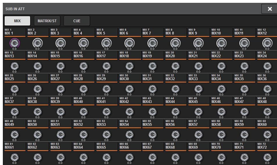
タブでアウトプットチャンネルを選択し、ノブで各チャンネルのゲインを調整します。
