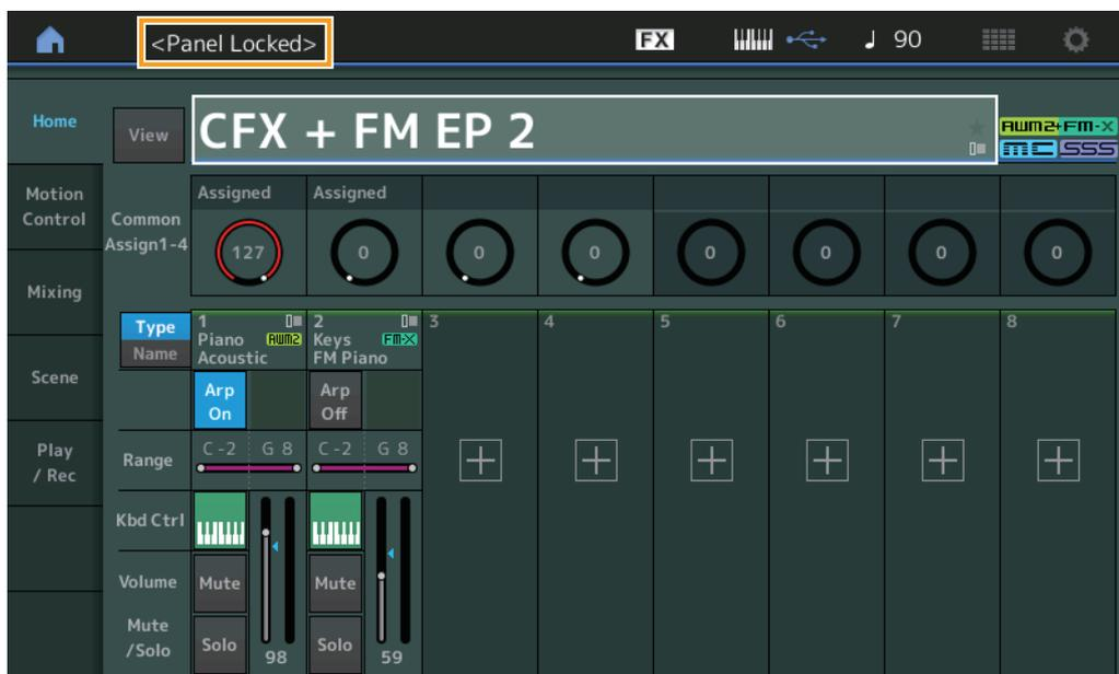
Para desbloquear el panel, pulse otra vez [SHIFT] + [AUDITION]. Cuando se active la función de bloqueo del panel, las operaciones dejarán de estar disponibles, excepto por el teclado, los pedales, el volumen principal, el mando maestro, la rueda de inflexión del tono, la rueda de modulación y la operación de desbloqueo. Este bloqueo también se aplica a las operaciones del panel táctil.
