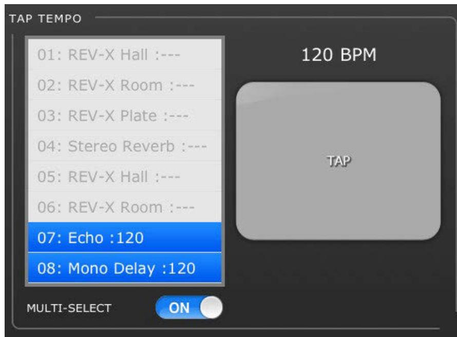
Seleccione el efecto relevante en la lista de 8 efectos, a la izquierda de esta sección. Los efectos que no tengan ningún parámetro de BPM aparecerán atenuados y no podrán seleccionarse.
