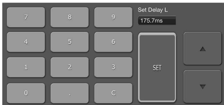
Pulse el botón para abrir el teclado numérico. Pulse los botones de cursor de Arriba/Abajo para ajustar el valor del parámetro paso a paso. El valor se enviará a la consola cada vez que se pulse el botón del cursor.
