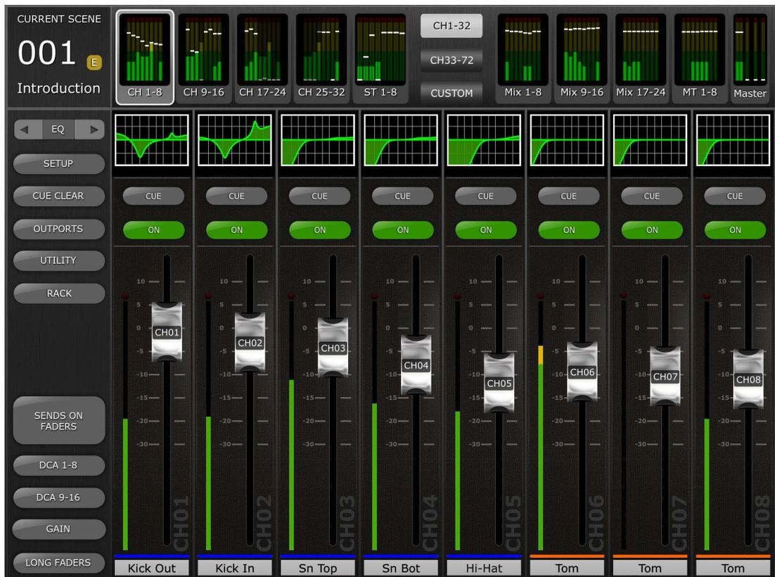
En la parte superior de la pantalla verá los vúmetros y los faders en bloques de canales, correspondientes a los canales de entrada monaurales del 1 al 32, los canales de entrada estereofónicos del 1 al 8, los buses Mix y Matrix, y los buses Master Stereo y Mono. Se trata del área “Navigation/Meter Bridge” (Navegación/Puente de vúmetro).
