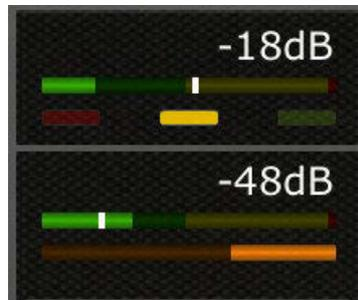
Dynamics 1 se muestra en la parte superior de la miniatura con Dynamics 2 en la parte inferior. (Los canales de salida solo tienen Dynamics 1).
