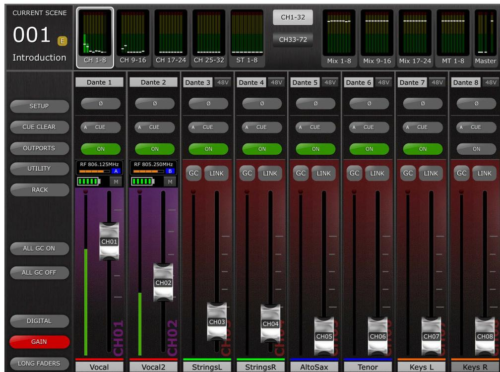
El fader controlará la ganancia de salida del canal de recepción inalámbrica (RX). Encima del fader, se indica el estado actual de la pila del micrófono inalámbrico. El estado de silenciamiento de la salida de audio del receptor (si está disponible en el receptor inalámbrico) se mostrará a la derecha del indicador de batería. Toque aquí para silenciar o anular el silenciamiento de la salida del receptor. Se mostrará un mensaje emergente de confirmación.
