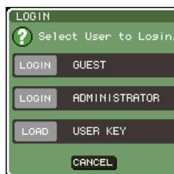
**4 Coloque el cursor en el botón LOAD USER KEY (Cargar clave de usuario) y presione la tecla [ENTER].**
