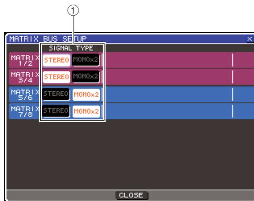
① **SIGNAL TYPE (método de proceso de señales)**
