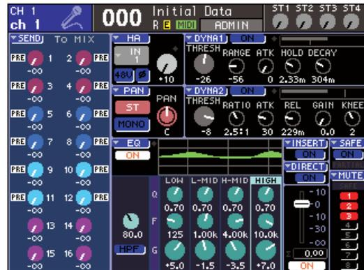
Utilice la sección DISPLAY ACCESS (→ pág. 19) para seleccionar la pantalla que desea ver. A continuación, las teclas de cursor de la sección de introducción de datos (→ pág. 22) para mover el cursor hasta el parámetro deseado y utilice el mando o las teclas [INC]/[DEC] (Aumentar/Disminuir) para editar el valor.
