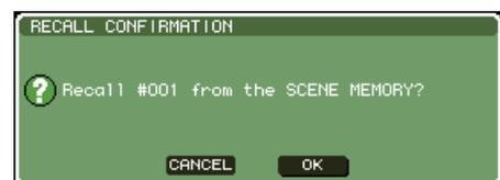
**4 Para realizar la operación de recuperación, coloque el cursor en el botón OK y presione la tecla [ENTER].**
