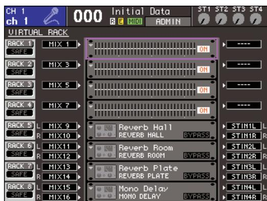
**2 Seleccione el canal (EQ/dinámica) o bastidor (GEQ/efecto) cuyos ajustes desee recuperar.**
