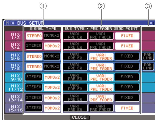
**1 SIGNAL TYPE (Tipo de señal) (método de proceso de señales)**
