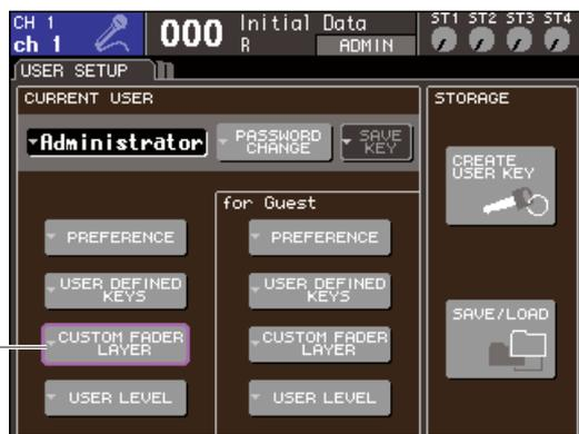
**2** Coloque el cursor en el botón emergente **CUSTOM FADER LAYER** de la pantalla y presione la tecla [ENTER] (Introducir).
