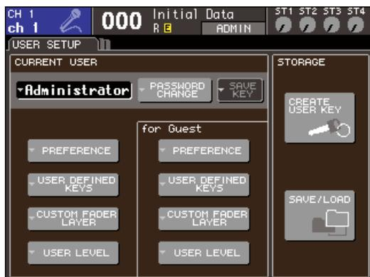
**2 Coloque el cursor en el botón SAVE/LOAD y presione la tecla [ENTER] para acceder a la ventana emergente SAVE/LOAD.**
