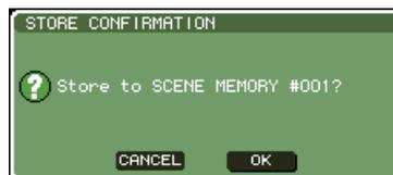
**7 Para efectuar la operación de almacenamiento, coloque el cursor en el botón OK (Aceptar) y presione la tecla [ENTER].**
