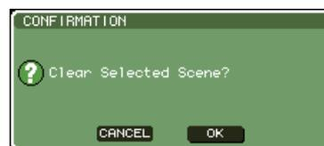
**4** Para ejecutar la operación de borrado, coloque el cursor en el botón **OK** y presione la tecla [**ENTER**].
