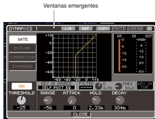
Mediante los botones y mandos de control de una ventana emergente, puede editar parámetros más detallados. En algunas ventanas emergentes, hay varios botones denominados "botones de herramientas" situados en la parte superior de la ventana. Puede utilizar estos botones de herramientas para recuperar o copiar/pegar datos de la biblioteca.
