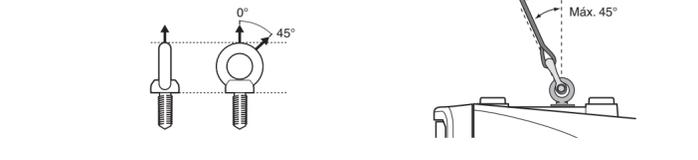
**Incorrecto:**No suspenda los cáncamos como se muestra en la ilustración de abajo.
