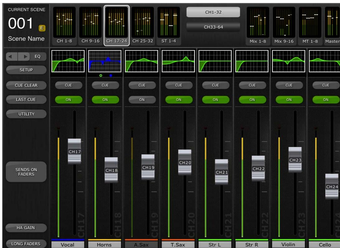
En la parte superior de la pantalla verá los vúmetros y los faders en bloques de canales, correspondientes a los canales de entrada monaurales del 1 al 32, los canales de entrada estereofónicos del 1 al 4, los buses Mix y Matrix, y los buses Master Stereo y Mono. Se trata del área “Navigation/Meter Bridge” (Navegación/Puente de vúmetro).
