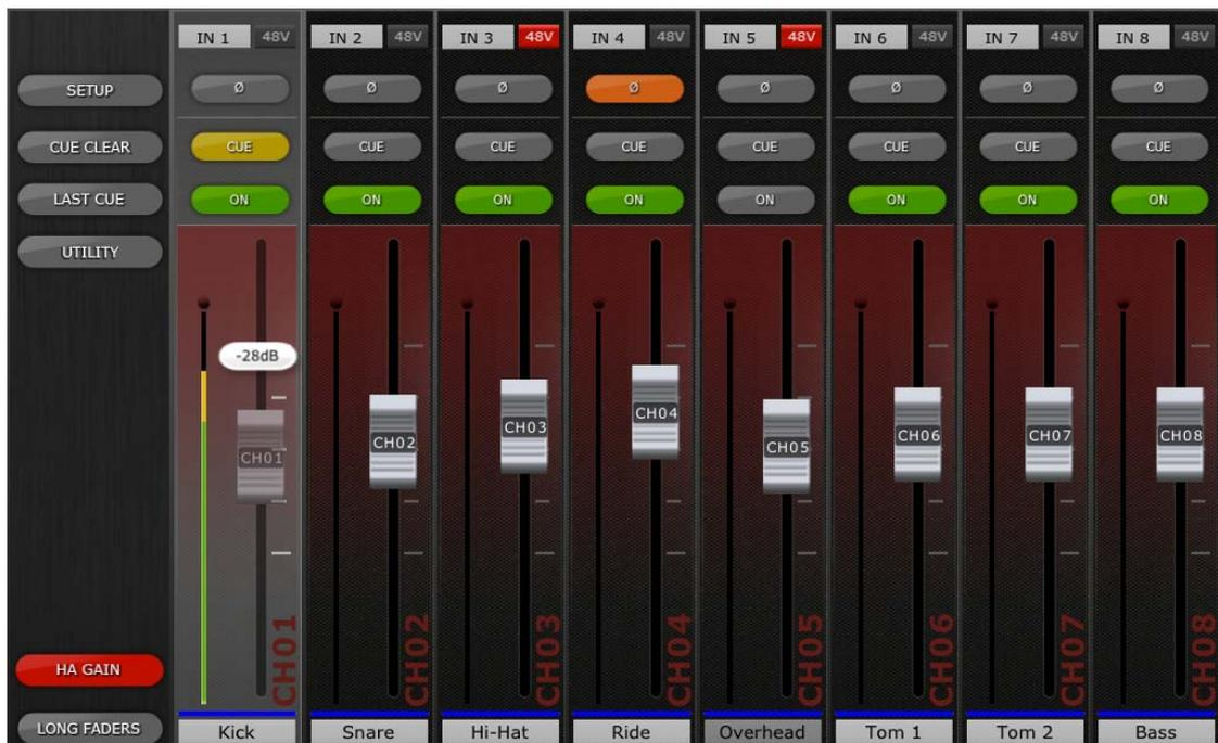
Los faders se pueden mover para cambiar el valor HA Gain de cada uno de los canales. El valor de ganancia de cada amplificador principal aparecerá encima del fader al tocar el mando de los faders. Se puede ajustar un máximo de 8 faders al mismo tiempo.
