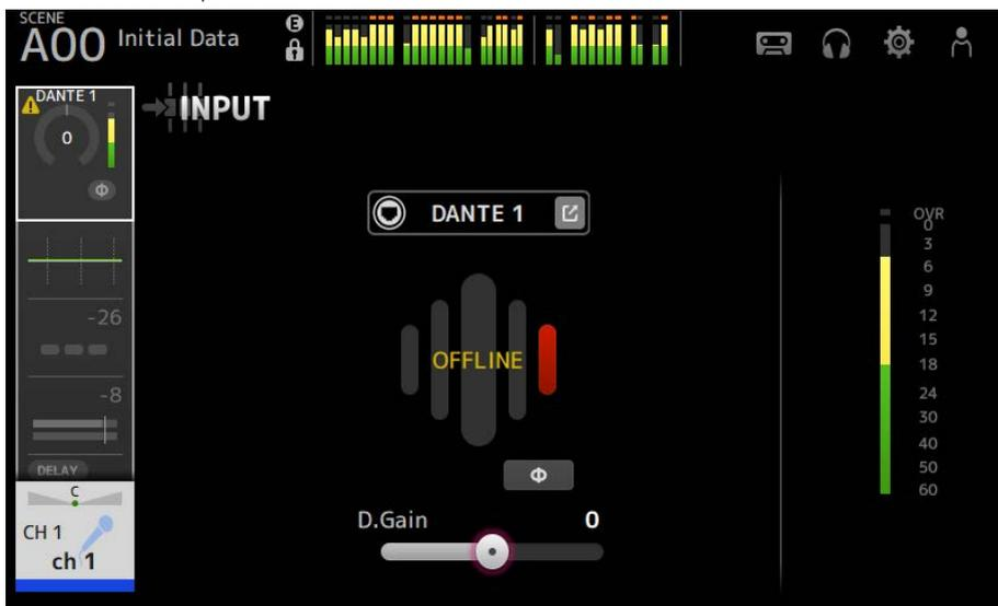
Si la fuente de entrada es DANTE, se muestra ERROR si se produce un error.
