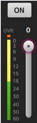
**4 Mientras consulta el indicador de nivel de la salida del oscilador, arrastre el deslizador de nivel del oscilador para ajustar el nivel de salida del oscilador.**
