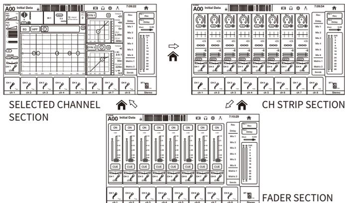
La pantalla de configuración permite realizar ajustes avanzados en los canales seleccionados.
