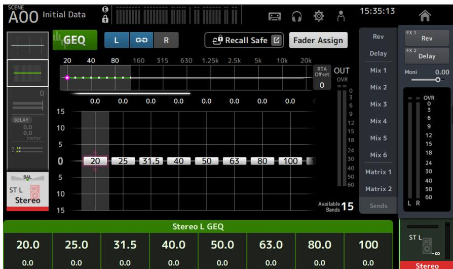
El ajuste de ganancia actual de cada banda se aplica a los faders en la sección de banda de canales del panel superior. Puede confirmar la frecuencia y la ganancia aplicadas a cada fader en el área de nombre del canal de la pantalla.
