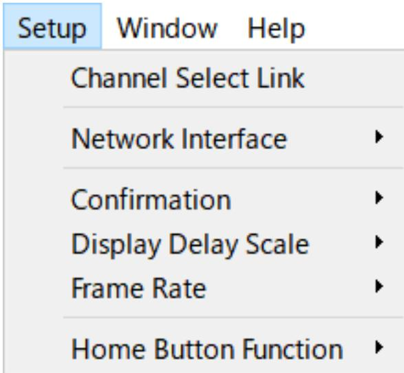
Cuando selecciona un elemento, este se marca y la función está activada. Vuelva a seleccionar el elemento para eliminar la marca de verificación y desactivar la función.
