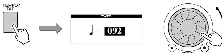
Puede volver al tempo original pulsando simultáneamente los botones [+] y [-]. Pulse el botón [EXIT] para volver a la pantalla MAIN.
