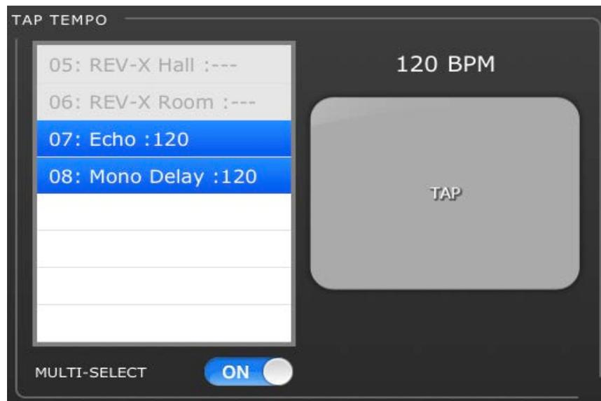
Seleccione el efecto relevante en la lista de 4 efectos, a la izquierda de esta sección. Los efectos que no tengan ningún parámetro de BPM aparecerán atenuados y no podrán seleccionarse.
