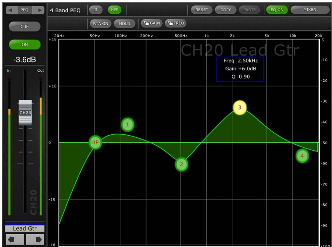
El nombre, color, fader, indicadores de nivel y botones [ON] y [CUE] se muestran en la columna izquierda. En la parte inferior izquierda verá los botones “anterior” y “siguiente” para navegar por los diferentes canales.
