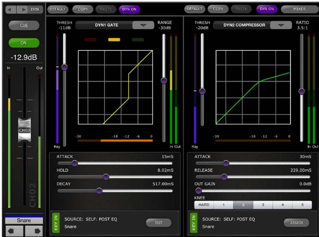
La parte izquierda de esta pantalla (Channel Strip) es idéntica a la pantalla de edición del ecualizador con el deslizador del canal, el botón de encendido, el botón Cue, los contadores de entrada y salida, el nombre del canal y los botones de color y navegación.
