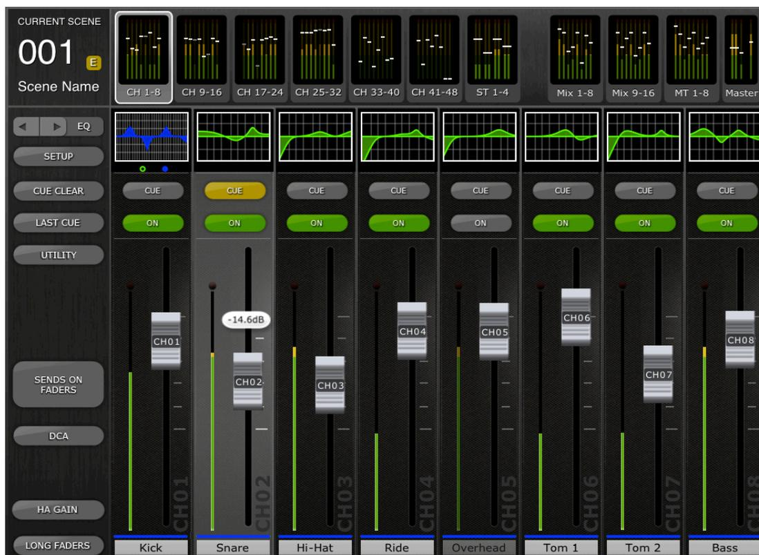
En la parte superior de la pantalla verá los vúmetros y los faders en bloques de canales, correspondientes a los canales de entrada monaurales del 1 al 48, los canales de entrada estereofónicos del 1 al 4, los buses Mix y Matrix, y los buses Master Stereo y Mono. Se trata del área “Navigation/Meter Bridge” (Navegación/Puente de vúmetro).
