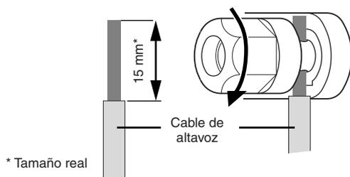
Verifique que los extremos desnudos de los cables no sobresalen los terminales y toquen el bastidor.
