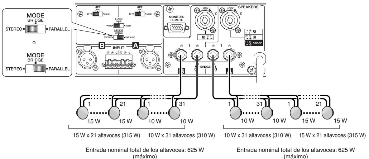
El XP3500 permite la conexión en **modo puentado** de varios altavoces de alta impedancia que admitan una salida de línea de **100 V**.
