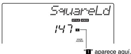
Ahora puede utilizar el mando A para ajustar la frecuencia de corte del filtro, y el mando B para ajustar la resonancia.
