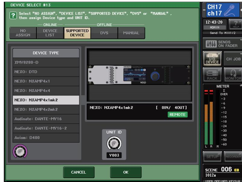
Значок (**REMOTE**) отображается на устройстве, поддерживающем дистанционное управление.
