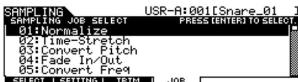
**3** Mueva el cursor hasta la tarea deseada con el dial de datos, los botones [INC/DEC] y [DEC/NO], o con los botones de cursor hacia arriba y hacia abajo y; a continuación, pulse el botón [ENTER/STORE].
