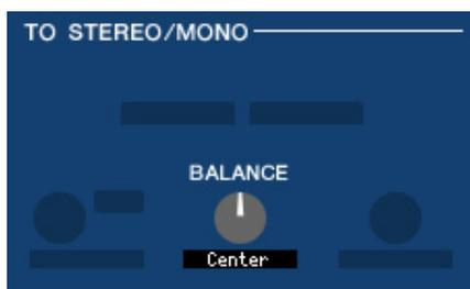
Ajusta el balance de volumen hacia la izquierda/derecha en el bus STEREO. Puede ajustarlo en el valor central manteniendo presionada la tecla <Ctrl> del teclado del ordenador y haciendo clic en este botón.
