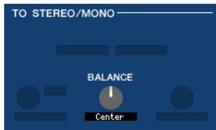
Este ajuste se muestra únicamente si el bus MATRIX seleccionado se está utilizando como estéreo. Ajusta el balance de volumen hacia la izquierda/derecha de la señal estéreo. Puede ajustarlo en el valor central manteniendo presionada la tecla <Ctrl> del teclado del ordenador y haciendo clic en este botón.
