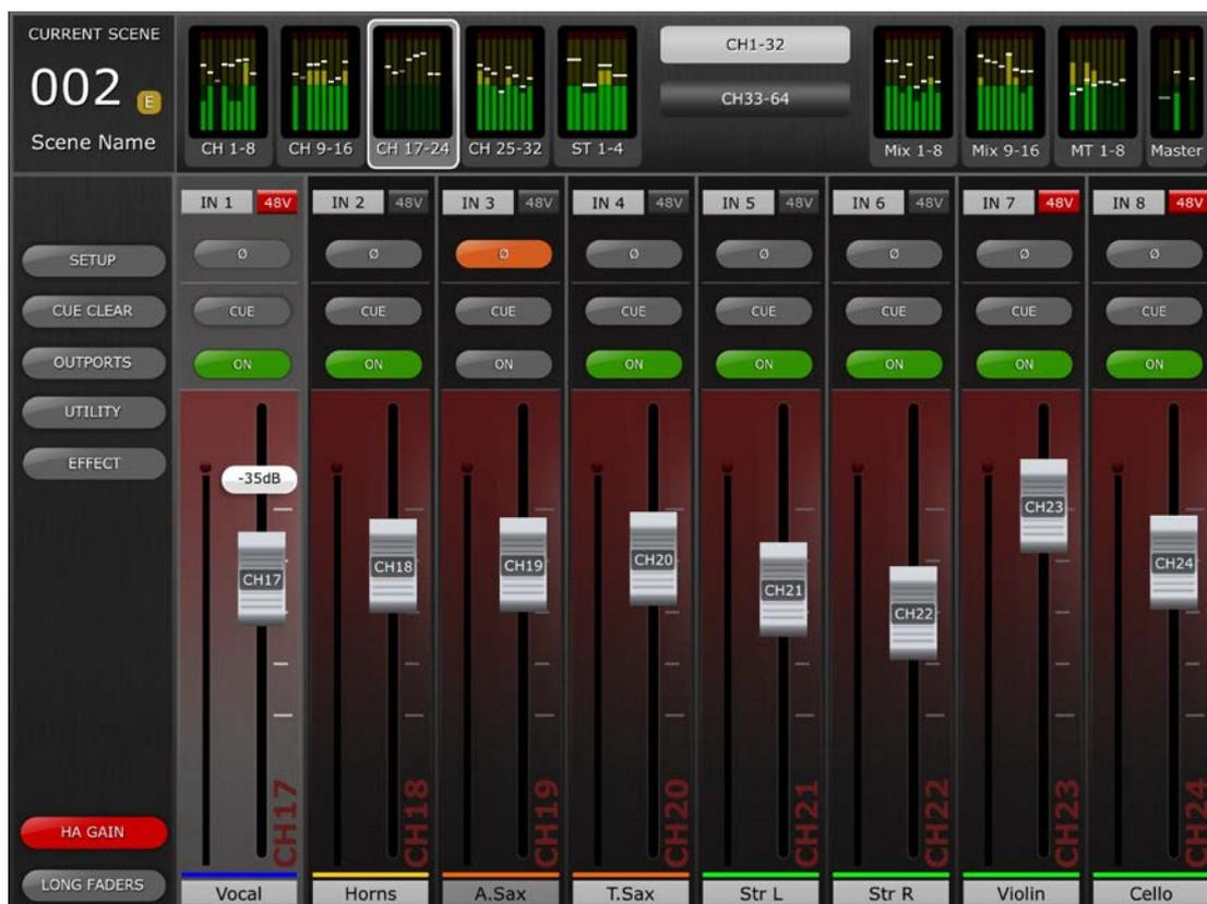
Los faders se pueden mover para cambiar el valor HA Gain de cada uno de los canales. El valor de ganancia de cada amplificador principal aparecerá encima del fader al tocar el mando de los faders. Se puede ajustar un máximo de 8 faders al mismo tiempo.
