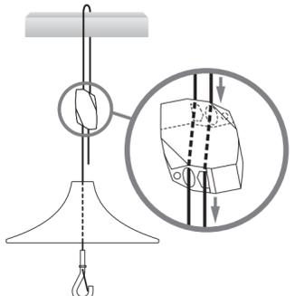
4. Encaje el gancho en el orificio central del soporte de suspensión en la parte posterior del altavoz.
