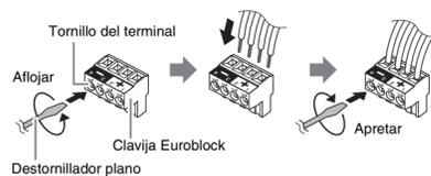
Utilice un destornillador plano con una punta de menos de 3 mm.
