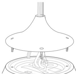
2. Después de aflojar los tornillos de los terminales de la clavija Euroblock con un destornillador plano, inserte los cables en cada terminal y vuelva a apretar los tornillos.
