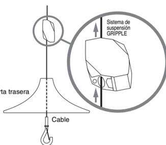
3. Cuelgue el cable roscado a través de la estructura del techo y páselo por el orificio ovalado del otro lado del sistema de suspensión GRIPPLE.
