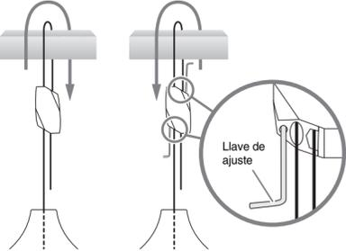
6. Fije el segundo cable a una estructura resistente que sea diferente de la estructura a la que fijó el cable en el paso 3, utilizando el mismo procedimiento que para el primer cable. Encaje el gancho en el orificio izquierdo o derecho del soporte de suspensión en la parte posterior del altavoz. Después de ajustar la altura, corte el cable sobrante.
