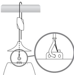
5. Ajuste la posición (altura) del altavoz. Para elevarlo, tire más del cable hacia delante. Para bajarlo, sostenga el altavoz para que no se caiga e inserte la llave de ajuste en el pequeño orificio situado en los lados izquierdo y derecho del sistema de suspensión GRIPPLE que desea aflojar y presiónela. El cable del orificio ovalado del lado presionado se desbloquea, lo que permite que el cable se mueva en la dirección opuesta a la posición del altavoz baje.
