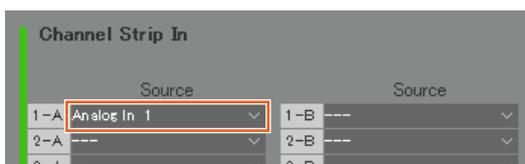
Nell'esempio mostrato nell'immagine precedente l'uscita "Analog 1" è assegnata a Channel Strip In 1-A in quanto l'uscita di preamplificazione del microfono è collegata al connettore ANALOG [INPUT 1] (ANALOGICA [INPUT 1]) dell'unità MMP1.
