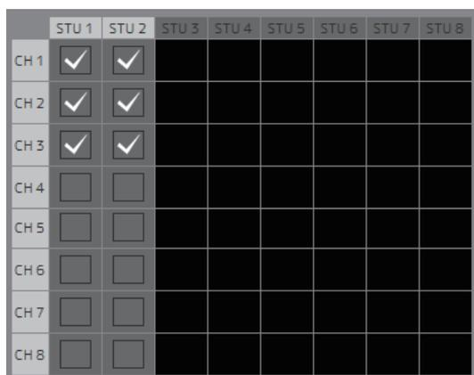
Questa funzione consentirà di escludere l'audio delle uscite degli altoparlanti di studio (☑ casella di controllo uscite selezionate) quando l'ingresso audio del microfono alla channel strip è impostato su "on".
