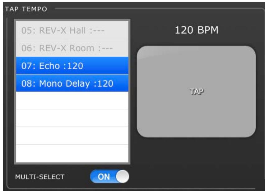
Seleccione el efecto relevante en la lista de 4 efectos, a la izquierda de esta sección. Los efectos que no tengan ningún parámetro de BPM aparecerán atenuados y no podrán seleccionarse.
