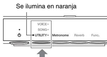
**6** Pulse el botón 3 [Func.] (Función) para introducir los ajustes de función.
