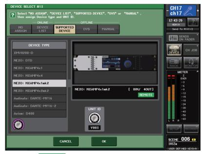
L'indicateur ( REMOTE ) apparaît sur le périphérique de commande à distance pris en charge. Le contrôleur NXAMPmk2 prend en charge la commande à distance avec la carte Dante (NXDT104mk2).
