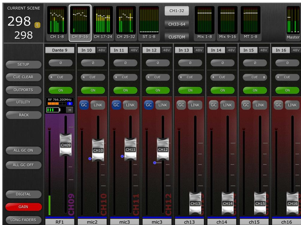
El fader controlará la ganancia de salida del canal de recepción inalámbrica (RX). El estado actual de la batería del micrófono inalámbrico se muestra encima del fader. El estado de silenciamiento de la salida de audio del receptor (si está disponible en el receptor inalámbrico) se mostrará a la derecha del indicador de batería. Toque aquí para silenciar o anular el silenciamiento de la salida del receptor. Se mostrará un mensaje emergente de confirmación.
