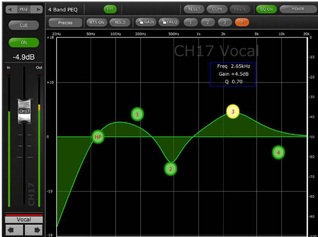
(La captura de pantalla anterior muestra la pantalla del editor del ecualizador con el firmware V4 de la consola QL.)
