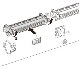
2. Para desconectar los conectores Euroblock, baje los cierres izquierdo y derecho y extraiga el conector.
