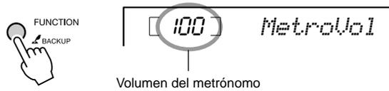
**2** Establezca el volumen del metrónomo utilizando los botones numéricos [0] a [9] y [+], [-].
