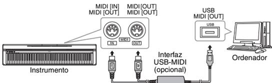
Puede conectar los terminales MIDI de este instrumento con el terminal USB del ordenador a través de un dispositivo provisto de la interfaz USB-MIDI opcional (como Yamaha UX16). Para hacer esto, es necesario que instale el controlador MIDI USB en el ordenador. Para obtener más información, consulte el manual de instrucciones que se suministró con el dispositivo provisto de la interfaz USB-MIDI.
