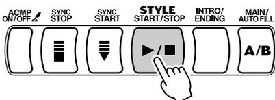
Podrá seleccionar la sección Principal A o B presionando el botón apropiado (MAIN A o MAIN B) antes de presionar el botón [START/STOP]. (La pantalla muestra brevemente la letra de la sección seleccionada: “MAIN A” o “MAIN B”.)
