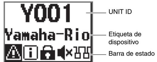
Esta es la pantalla que aparece al encender el interruptor de alimentación. En la fila superior se muestra el identificador de unidad (UNIT ID). El valor inicial es Y001. En la fila central se muestra parte de la etiqueta de dispositivo. En la fila inferior se muestra la barra de estado, que utiliza iconos para indicar el estado de la unidad.
