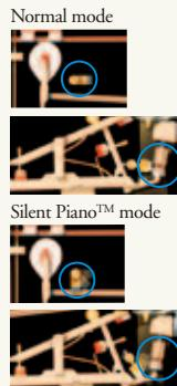
El sistema Yamaha QuickEscape garantiza el escape automático del martillo tanto para su funcionamiento en modo acústico o en modo Silent.
